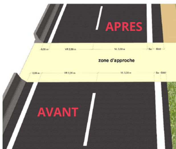
Schéma concernant la redistribution de la largeur des voies de circulation
